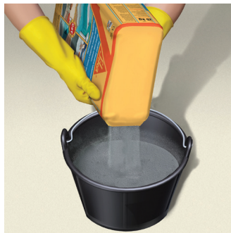
Cho nước sạch vào xô, từ từ cho phần bột vào trộn đều theo tỉ lệ 5 kg Sika® Tilebond GP với 1 lít nước
