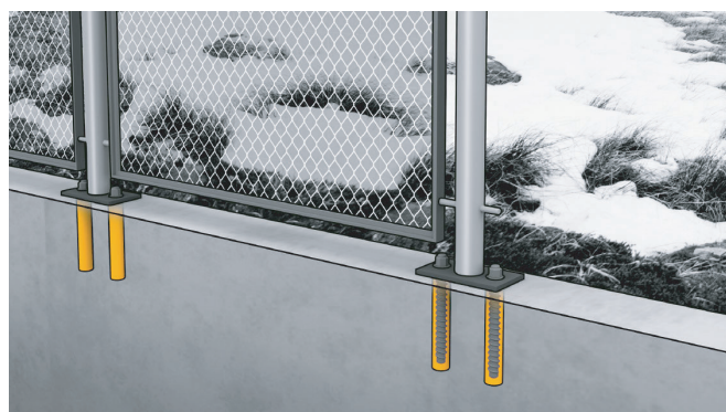
Lắp đặt hệ thống rào chắn và cơ chế chống rơi.
