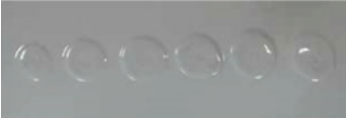
Giọt nước hằn sâu bề mặt màng PU
